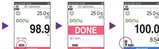
5. Plongez l'électrode OD dans une solution nulle (sulfite de sodium à 0,2%) et répétez les étapes 3 - 4 pour effectuer l'étalonnage du zéro (facultatif).
