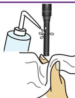
Il ne doit y avoir aucune gouttelette d'eau sur le bouchon d'OD ni sur le capteur de température.
